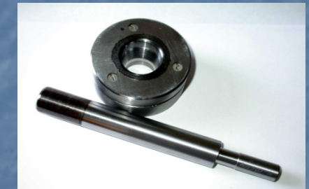
Комплект вытяжного штампа после лазерной обработки (матрица – ШХ15; пуансон – Х12М)
