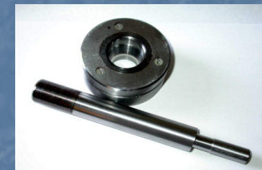
Вытяжной штамп (матрица – ШХ15; пуансон – X12M)
