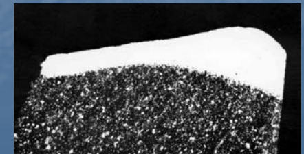
Поперечный шлиф зуба развертки P9K5 после лазерной обработки. \times 100
