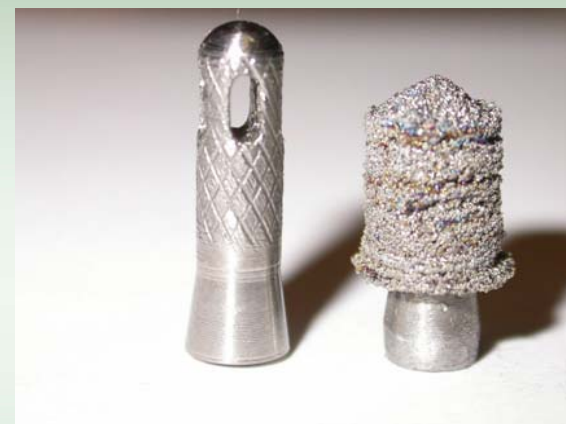
Послойная 3D наплавка порошка титана на титановый стоматологический штифт
