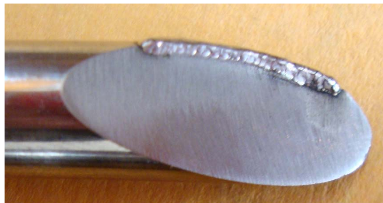
Наплавка направляющих штоков прессформы
