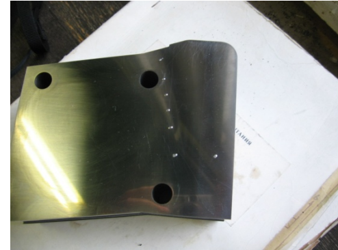
Вставка деталь после лазерной наплавки
