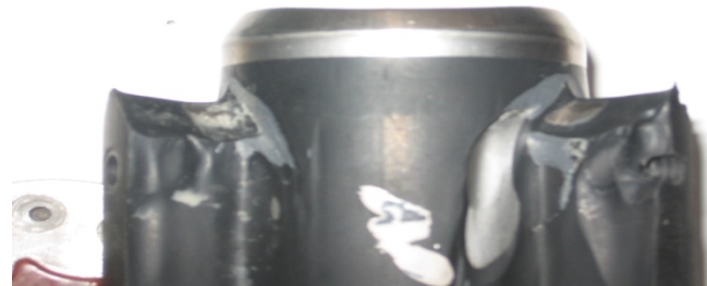
Корпус измерителя после 49 часов эксплуатации
