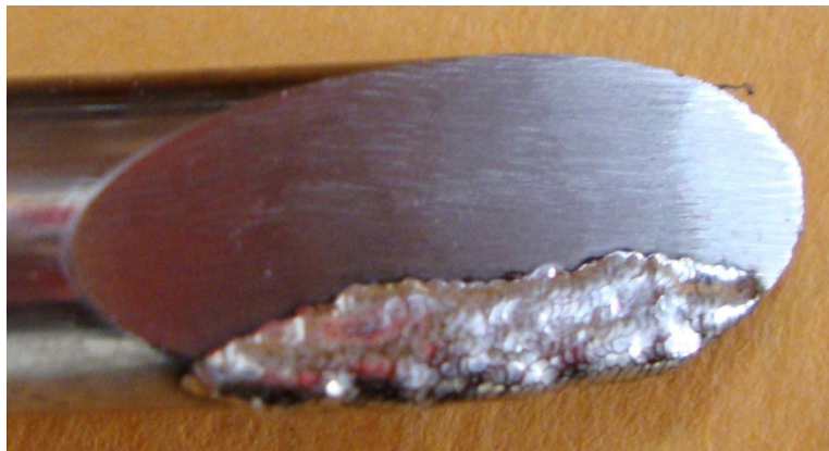
Наплавка направляющих штоков прессформы
