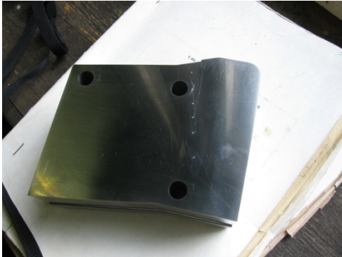
Вставка литьевой прессформы остекления передней блок-фары автомобиля со следами механических дефектов
