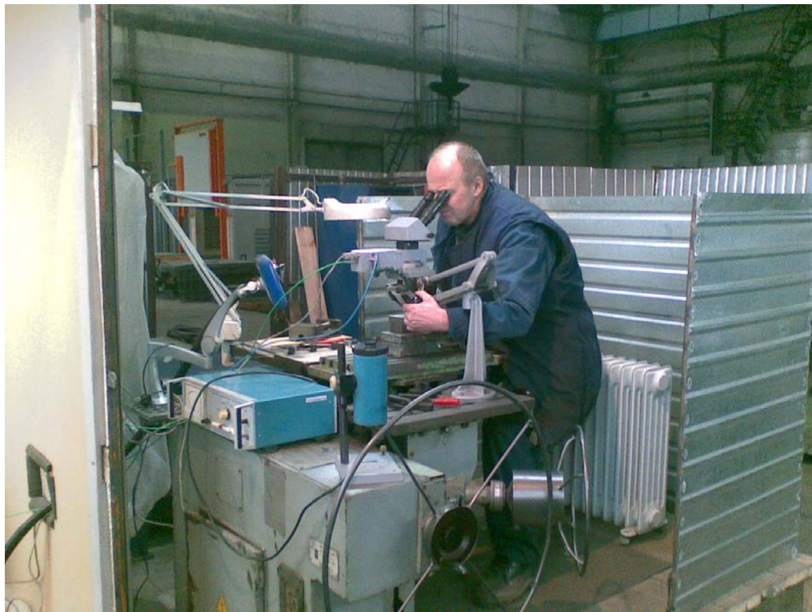
Рабочее место оператора на установке импульсной лазерной наплавки элементов прессформ (г.Ульяновск)
